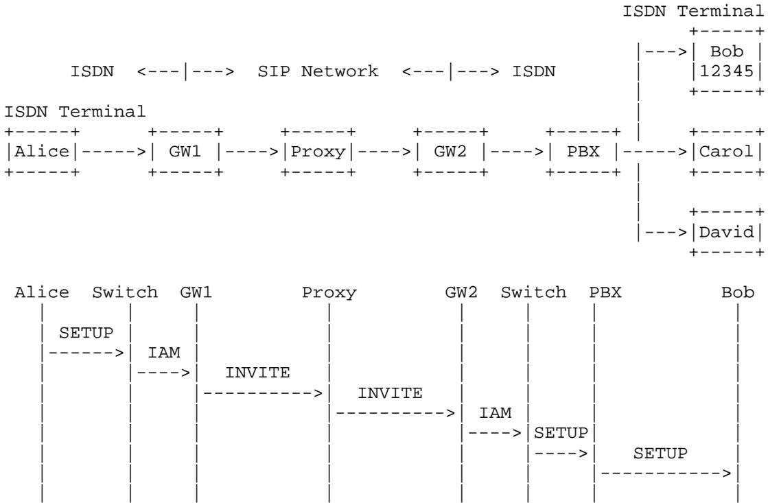
Figure 2: ISDN-SIP-ISDN Interconnection
